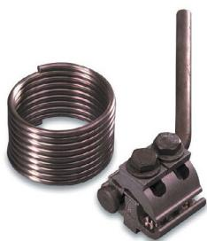
جرقه گیر وسیله حفاظت از هادیهای روکشدار در برابر صاعقه می‌باشد این نوع جرقه گیر مخصوص شبکهایی بوده که فواصل بین فازها کمتر از ۶۰ سانتی متر است. این یراق همچنین حاوی یک سیم آلومینیومی با سطح مقطع ۲۵ میلیمتر مربع و طول ۲۰.۱ متر می‌باشد که می‌بایست به دور مقره و هادی پیچیده شود و در زیر کلمپ و در کنار شاخص سفت گردد.
